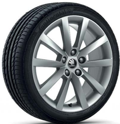
Kolo z lehké slitiny Alaris 7,5J x 18" pro pneumatiky 225/40 R18, ve stříbrné barvě (5E0 071 498D 8Z8) ŠKODA Originální příslušenství
